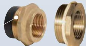
Kit que transforma un enlace REXUO sustituyendo la guarnición por el adaptador, en salida rosca gas hembra. No se necesita hilo de PTFE. REXUO Ø ext 20 a 63mm, salida rosca 1/2" a 2".
