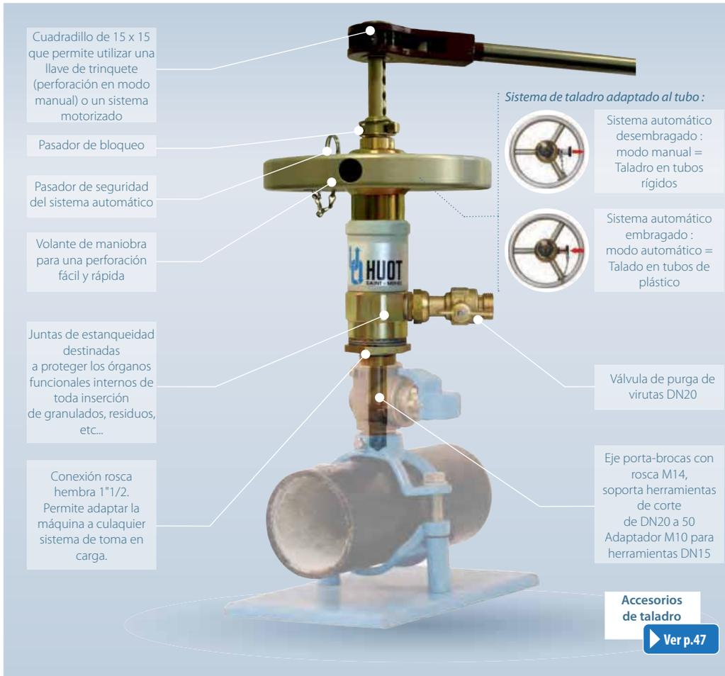
Cuadrado de 15 x 15 que permite utilizar una llave de trinquete (perforación en modo manual) o un sistema motorizado
