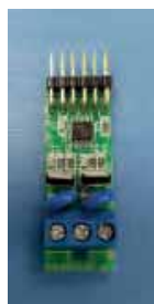
Modulo de expansión para programador Filtmaster ref 098806. Cada modulo de expansión amplía dos salidas sobre las que ya incluya el programador.
